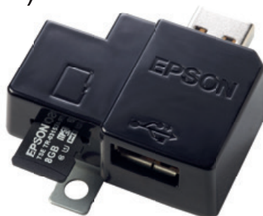
Epson Fiscal-Module (Upgrade-Kit aus USB-Hub und microSD-TSE)
